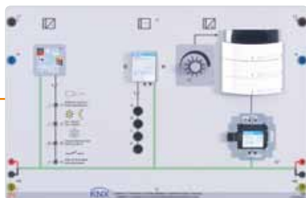
Panel complementario EIT 8.3: Control de calefacción
